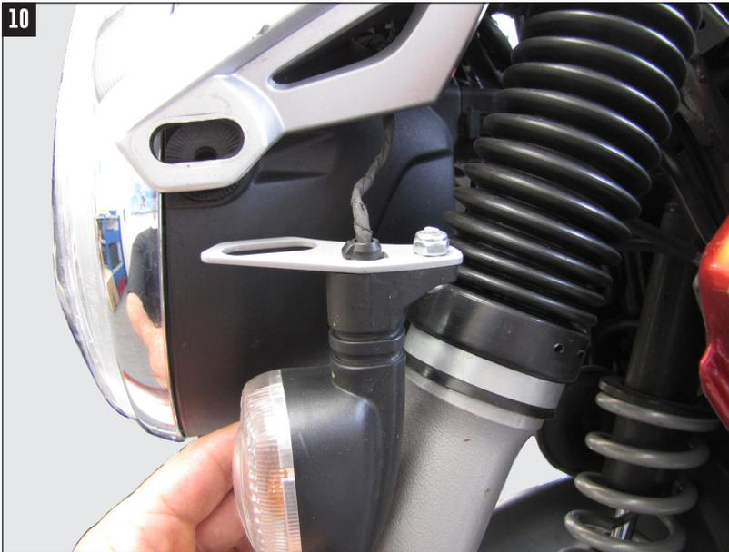
Entfernen Sie auf einer Seite die Halteschraube des Scheinwerfers, ziehen den Plastikeinsatz heraus und montieren ihn zusammen mit dem Blinkerhalter wieder am Scheinwerfer.
