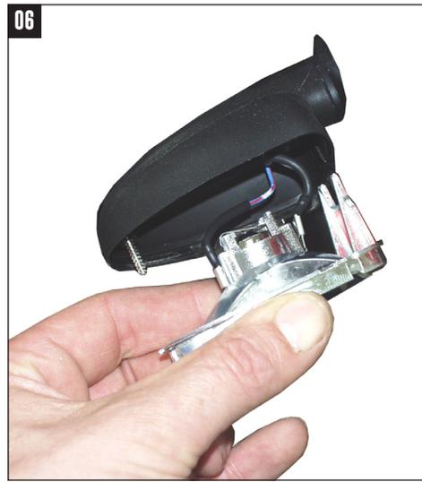
Demontieren Sie das Blinkerglas, nehmen Sie den Reflektor heraus und ziehen Sie die Kabelstecker ab.
