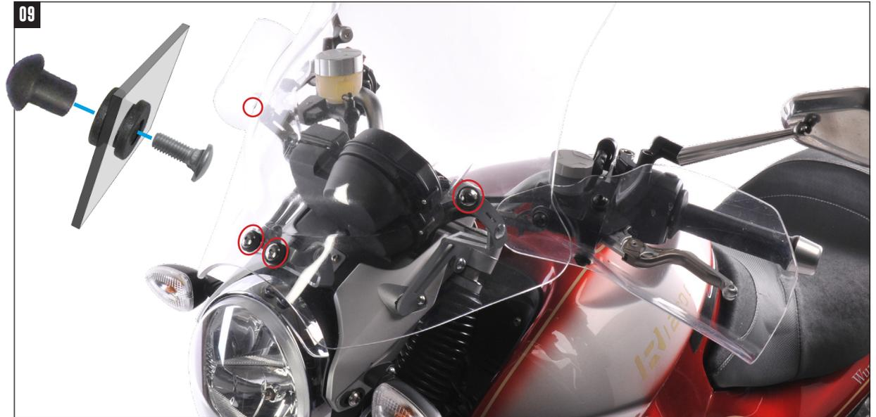
Die Durchführungsgummis werden an den vier Befestigungspunkten der Scheibe montiert. Bauen Sie die Scheibe an den Befestigungspunkten mit den Schloßschrauben und Gewindehülsen oben und unten an, und richten Sie sie vor dem Festdrehen aus.
