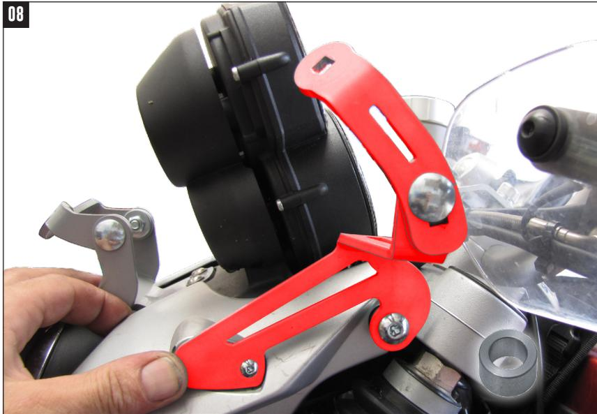
Befestigen Sie noch lose die beiden Grundhalter hi. mit der Schraube M8 und Hülse oben und Schraube M6 unten am Fahrzeug. Die Scheibenhalter hi. werden mit Schlossschraube, U- Scheibe und selbstsichernder Mutter von außen am Grundhalter montiert.
