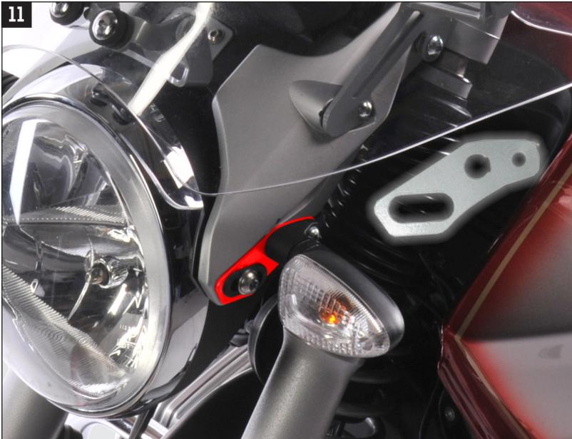
Montieren Sie den Blinker mit der Schraube M6, U- Scheibe und Mutter am Halter und schließen ihn wieder an. Kontrollieren Sie die Funktion der Blinker.
