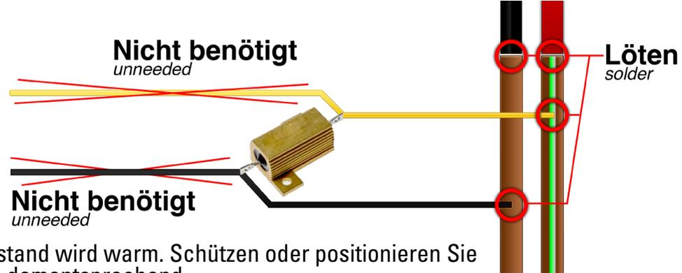
Widerstand wird warm. Schützen oder positionieren Sie diesen dementsprechend.
