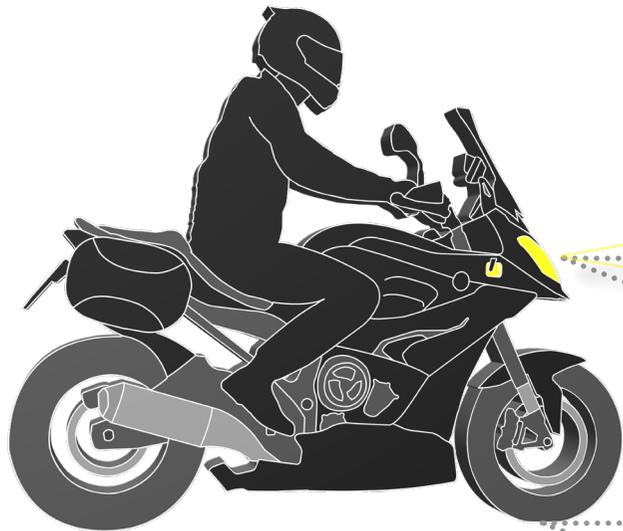
**ZUR EINSTELLUNG DER SCHEINWERFER MUSS DAS MOTORRAD MIT DEM FAHRER BELASTET SEIN.**
