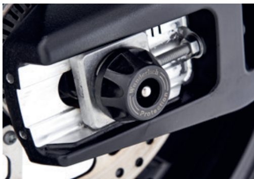
Achs-Schutzpads Hinterrad DOUBLESOCK schwarz | #42159-102
