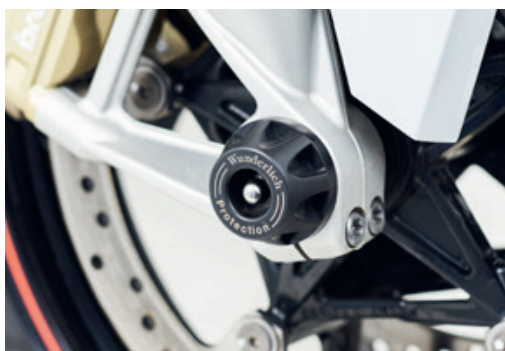
Achs-Schutzpads Vorderrad DOUBLESHOCK S 1000 R/RR | schwarz | #42158-002
