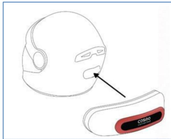
Pro dokonalé připevnění k helmě doporučujeme, aby Cosmo Moto a helma byli 72 hodin před instalací umístěni v místnosti s alespoň 20 °C. Poté postupujte následovně. Pečlivě odstraňte zadní část helmy pomocí hadíku a nechte 1 minutu oschnout. Vyzkoušejte, jak na
