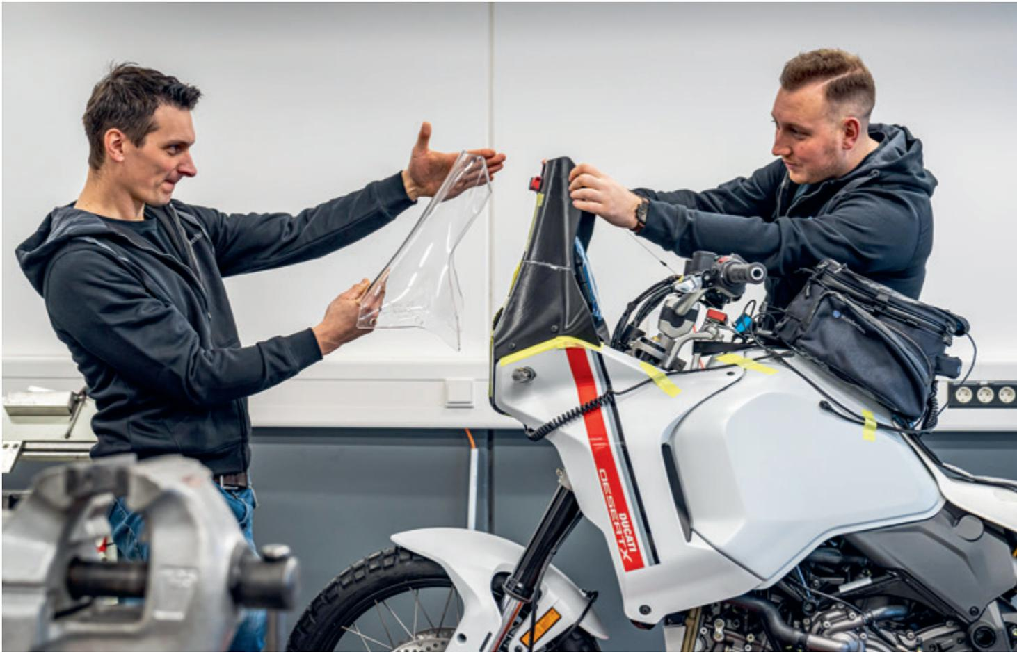
**Die Stunde der Wahrheit: Passt die erste serienmäßig hergestellte MARATHON Scheibe? Noch ist der gedruckte Prototyp montiert.**
