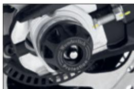
Achs Schutzpads an der Hinterachse
