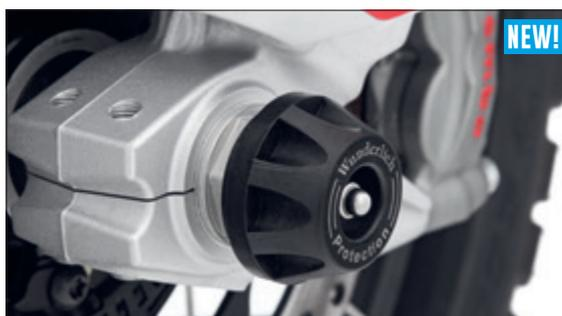
Achs Schutzpads an der Vorderachse
