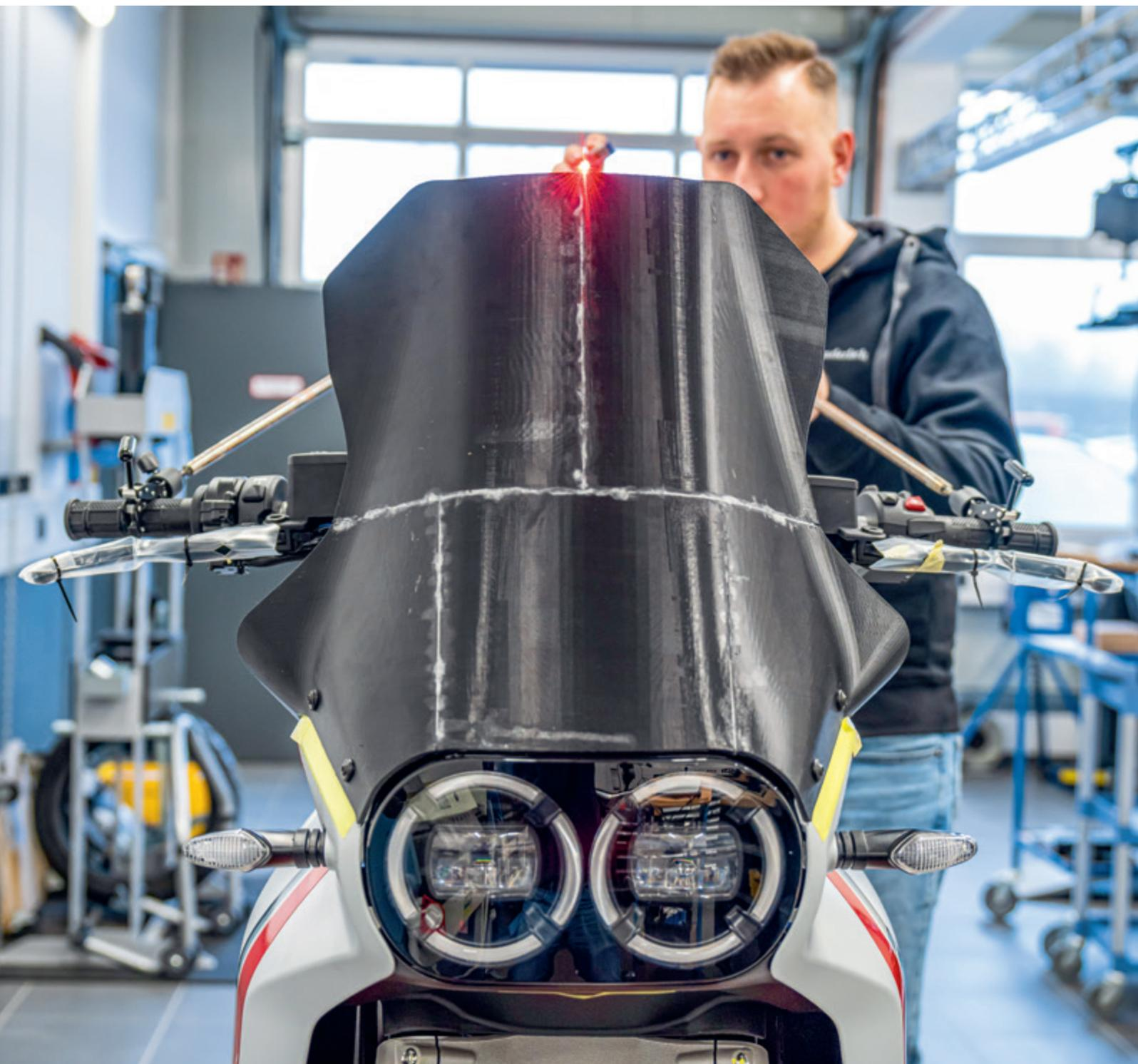
**Der Laser lügt nie: Festlegung der Scheibenhöhe mit Hilfe eines Laserstrahls.**
