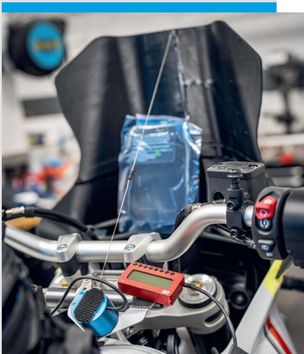
**Datalogging:** Die Kabel der Sensorik laufen im Tankrucksack zusammen.
