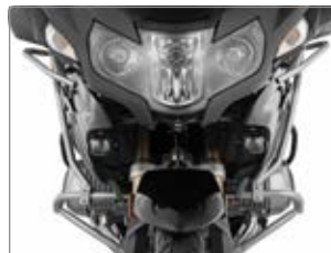
Zusatzschutz für Spiegel-/Blinkereinheit und stabile Aufnahmepunkte
