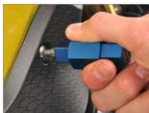
Anwendung als Schraubendreher.
