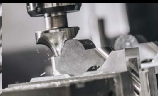
Fräsung des formschlüssigen Sitzes im Unterteil
