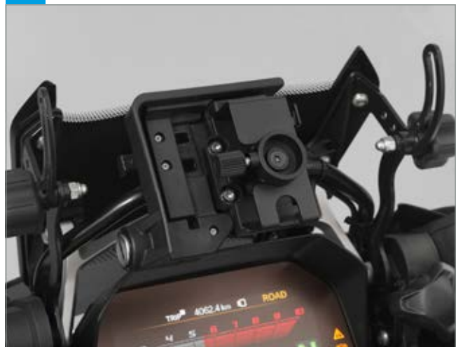
Adapter Handyhalterung »MultiClamp« für Original-Navihalterung montiert
