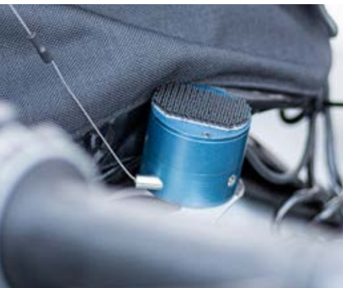
Wegsensor zur Aufnahme Auslenkung der Scheibe bei unterschiedlichsten Umgebungs- und Lastbedingungen
