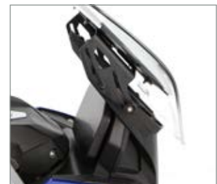
höchste Position entspricht einer Erhöhung von 60 mm
