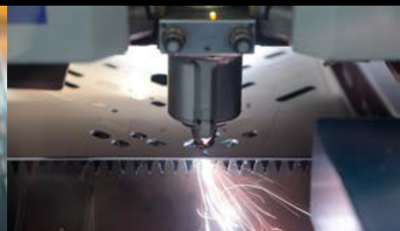
Laser schneidet computergesteuert die Aussparungen
