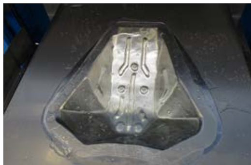
... geformte Motorschutz in der Matrize
