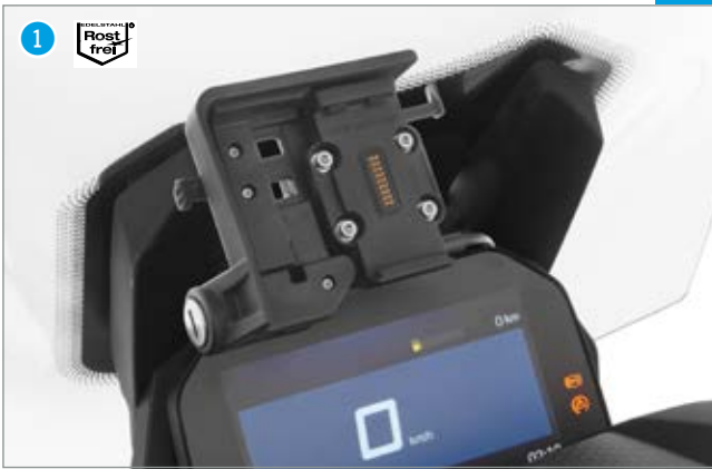
Geräteträger (Art.-Nr.: 21097-002) mit original Navigator-Halterung – die Navigator-Halterung ist nicht im Lieferumfang enthalten
