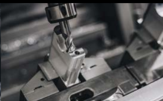
Bohroperation im Unterteil der Lenkererhöhung
