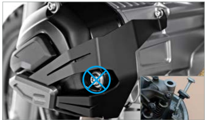
Rundumschutz – auch an der Ventildeckel-Unterseite
