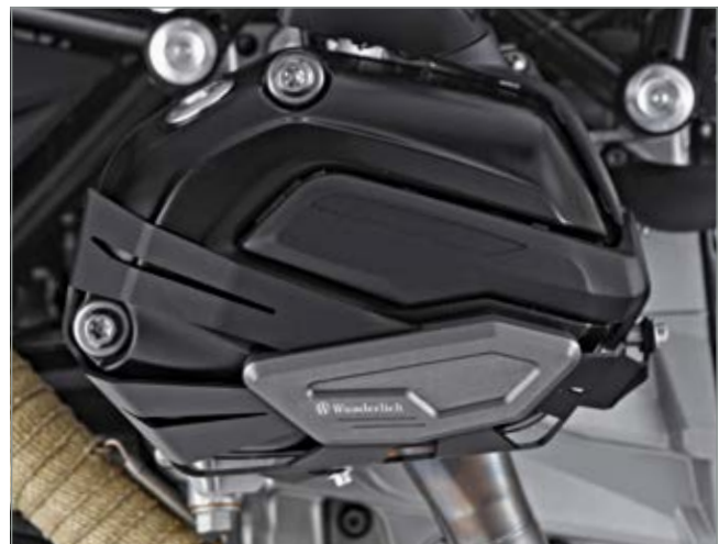
Rundumschutz – auch an der Ventildeckel-Unterseite
