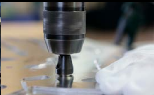
Die Bohrungen werden mit einem Kegelsenker »gesenkt«
