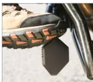
Außenverzahnung als Ausklapphilfe
