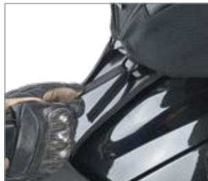
Zusatzbefestigungen hinten für Offroad/schwere Beladung
