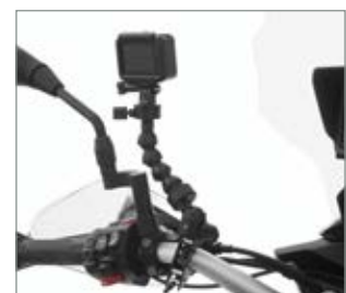
Gelenkarm »MultiClamp« kombiniert mit ActionCam-Halterung »MultiClamp«
