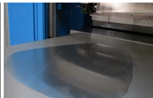
... über der Matrize positioniert
