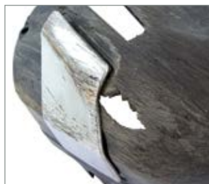
Nach einem Sturz – der Ventildeckel blieb unversehrt
