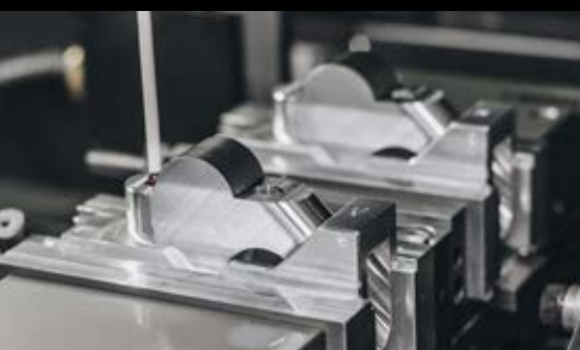
Computergestützte Maßkontrolle mit Rubinsteinspitze
