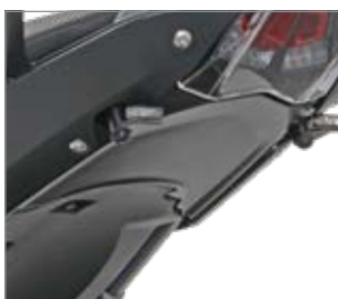
Innenverkleidung zur Abdeckung der Original-Kennzeichen-Verschraubung
