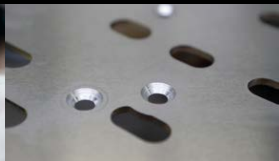
Dies erlaubt das bündige Verschrauben
