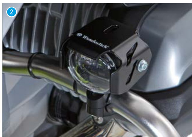
LED-Zusatzscheinwerfer »MicroFlooter«, Bügel-/Rohrmontage
