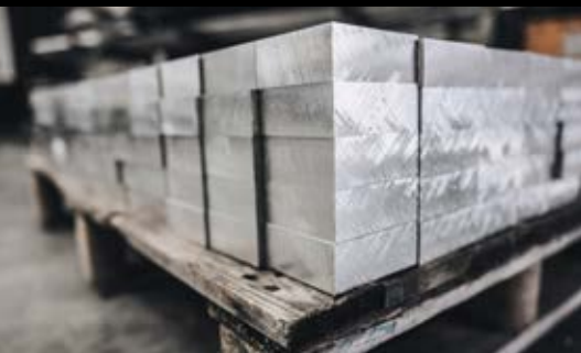
Aluminium-Barren zur Herstellung der Lenkererhöhung
