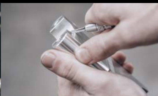
Die Kanten werden vom Werkzeugmacher gebrochen
