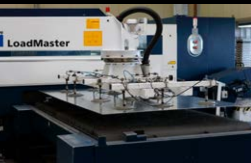
Aufnahme auf dem Tisch des Laserschneidzentrums
