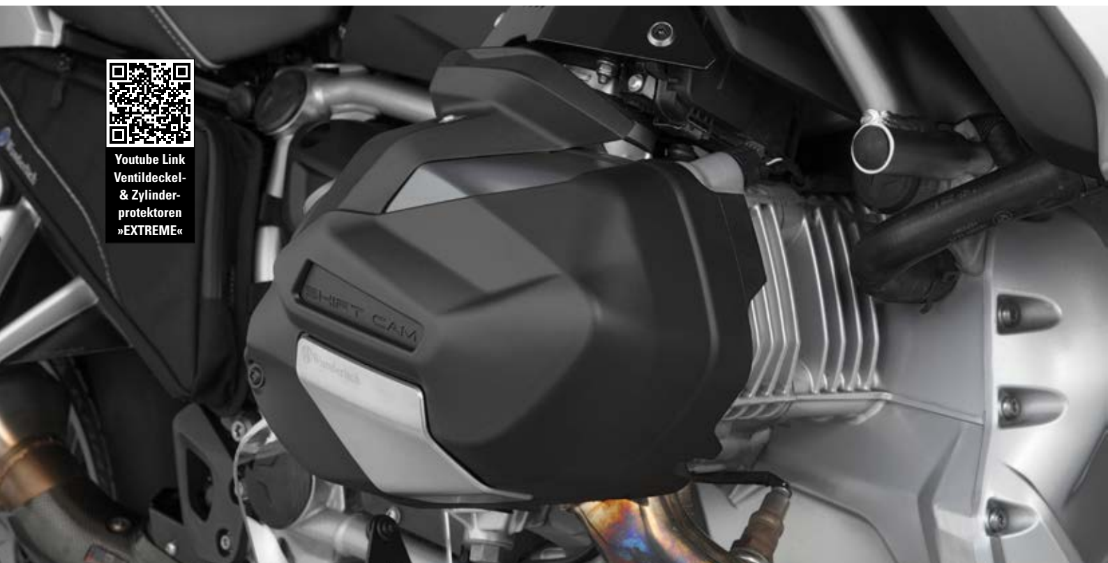
Nach einem Sturz – der Ventildeckel blieb unversehrt
