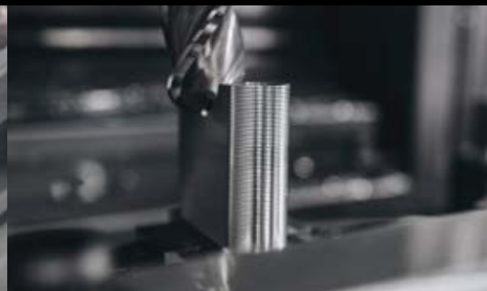
Präzise Formfräsung der oberen Formung
