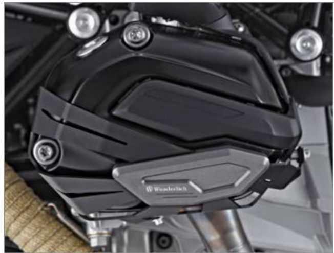
Rundumschutz – auch an der Ventildeckel-Unterseite
