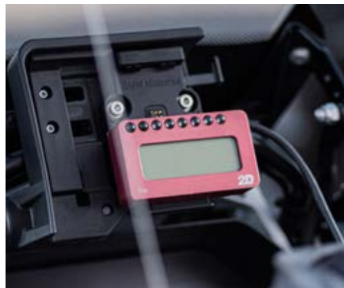
Echtzeit-Datenanzeige: Zeigt die Can-Bus- und die Daten der Sensoren und des GPS-Systems an
