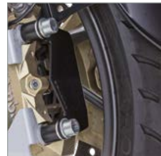
Mit integriertem Bremsättelschutzfang
