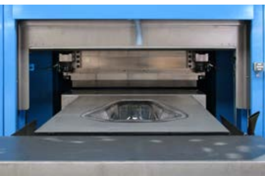
Hydroforming-Anlage mit der Matrize
