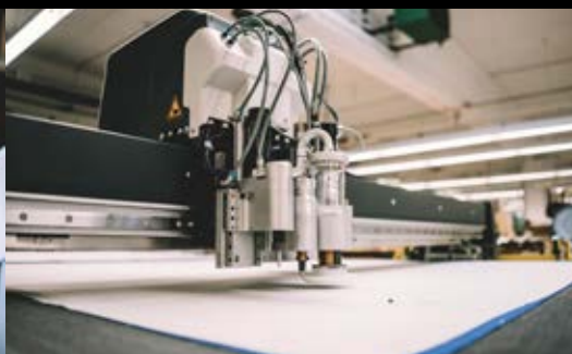
CNC-Zuschnitt der hochwertigen Gewebe
